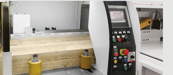
**Unidad de corte sólida para cortar paquetes y molduras con la máxima rapidez y precisión**
